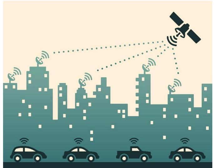
satellite qui fournit les informations nécessaires. Pour **améliorer la précision des systèmes de navigation** dans ces environnements, les VC peuvent dépendre de l'échange de données entre eux et utiliser la force et la direction des signaux reçus pour appliquer des techniques mathématiques de localisation afin de déterminer avec précision leur emplacement<sup>12</sup>.
